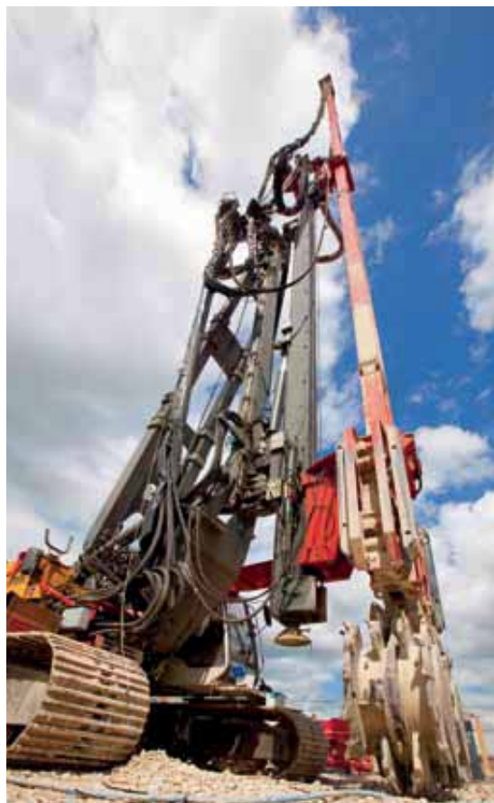
LA HIDROFRESA XS es más compacta que el modelo estándar y permite la realización de pantallas de hormigón de menos de 630 mm de grosor.
